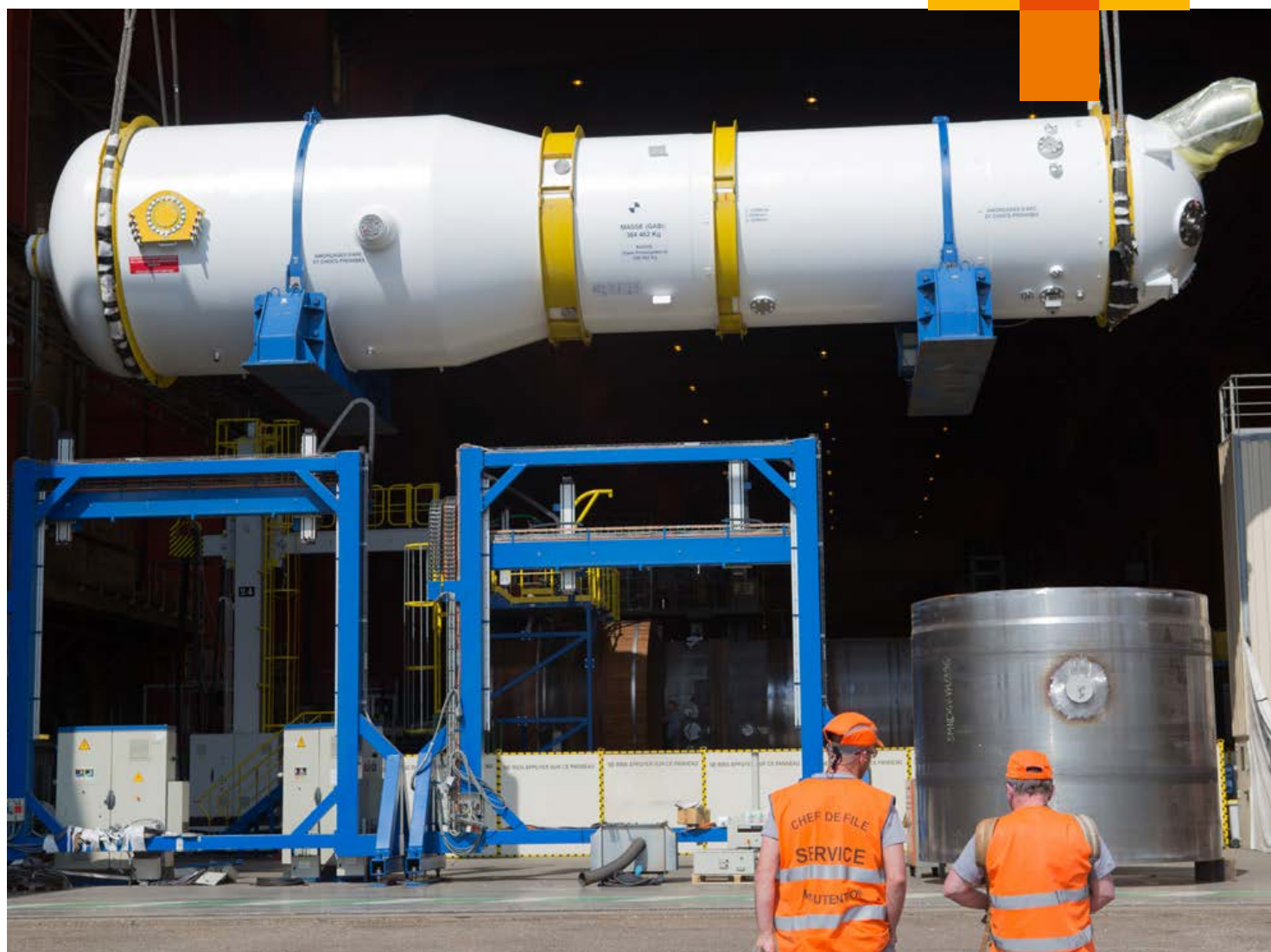
Générateur de vapeur d'un EPR une fois les pièces forgées assemblées
